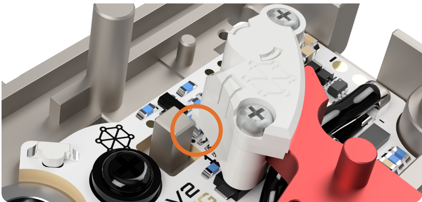
Držák magnetu se musí opírat o doraz kontaktů
